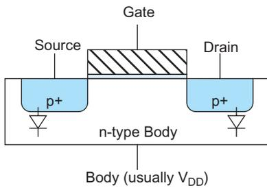
FIGURE 2.4 pMOS transistor
