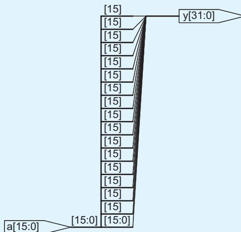
**FIGURE A.12** Sign extension**A.2.10 Delays**
